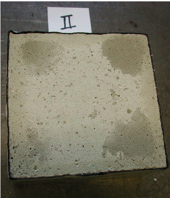
Bild A 5.2: Probe II nach dem Befrosten
