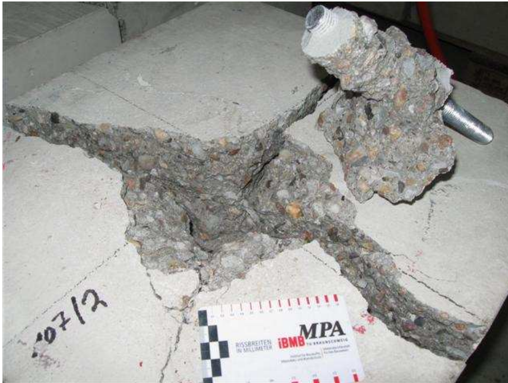
Bild A 5: Probe 2 – Nach Auszugsversuch (Versagenstyp 3) mit anhaftendem Betonmaterial
