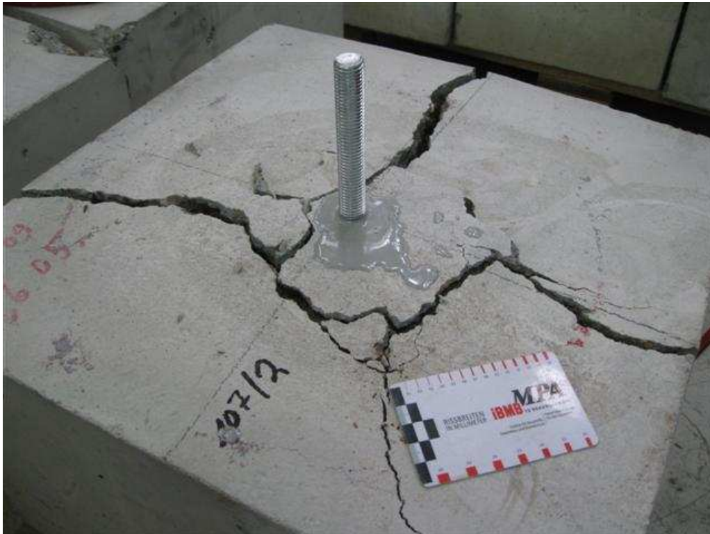
Bild A 4: Probe 2 – Nach Auszugsversuch (Versagenstyp 3)
