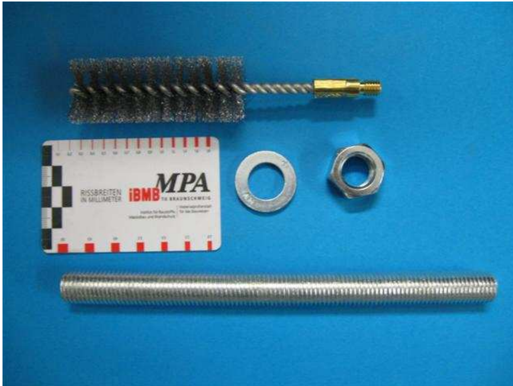
Bild A 1: Faschenbürste und Gewindestange der Güte 4.6 (M 16, l = 200 mm)
