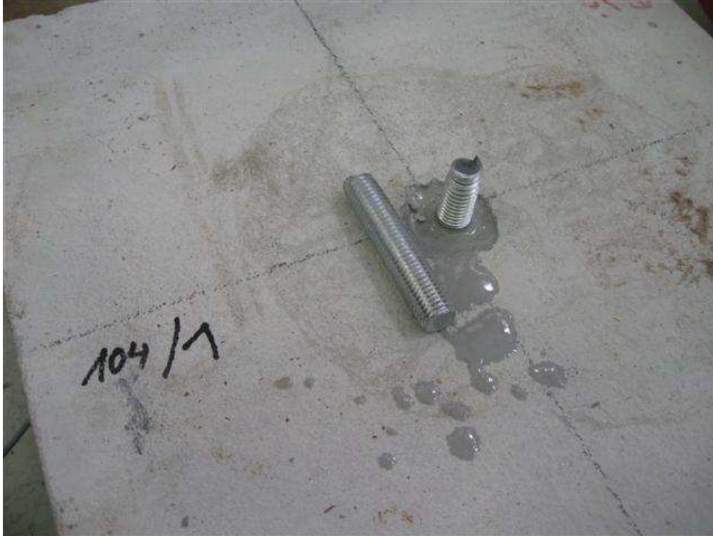
Bild A 3: Probe 1 (exemplarisch) – Nach Auszugsversuch (Versagenstyp 1)
