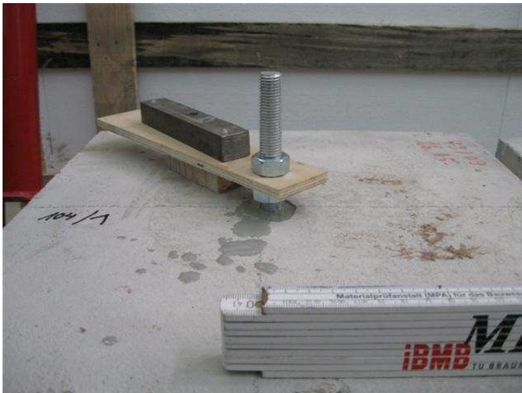
Bild A 2: Probe 1 (exemplarisch) – Eingeklebte und im Bohrloch zentrierte Gewindestange
